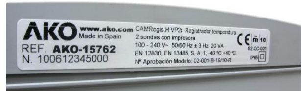
Fig. 4. Etiqueta de características de un registrador sometido a control metroológico
